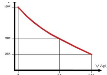
Профиль заряда «Wa» для АКБ с жидким электролитом
